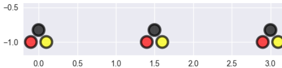
Bild 2.2.7. Tvärsnitt av tre nedgrävda kabelförband
